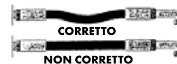
FIG. 5 - TOLLERANZE SUL TUBO
