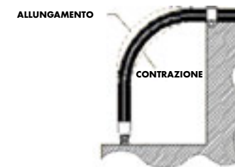
FIG.6 - ALLUNGAMENTO E CONTRAZIONE DOVUTE ALLA PRESSIONE
